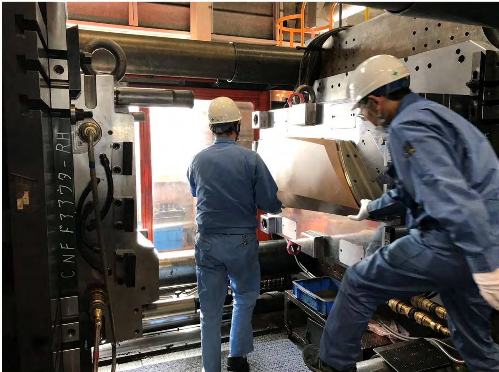
NCVでドアアウターを成形した際の金型から部品を取り出すところ(材料はPP-CNF10)
