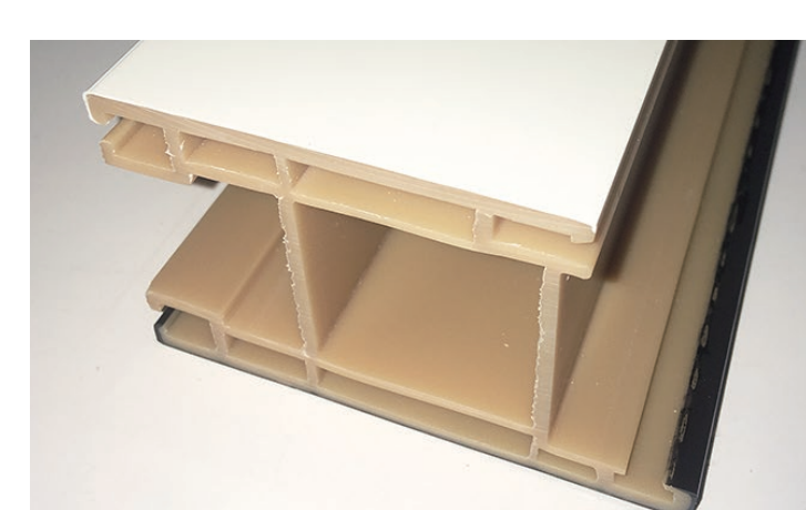
竹CNF含有塩ビコンポジット押出成形品 (CNF7wt%混合)
