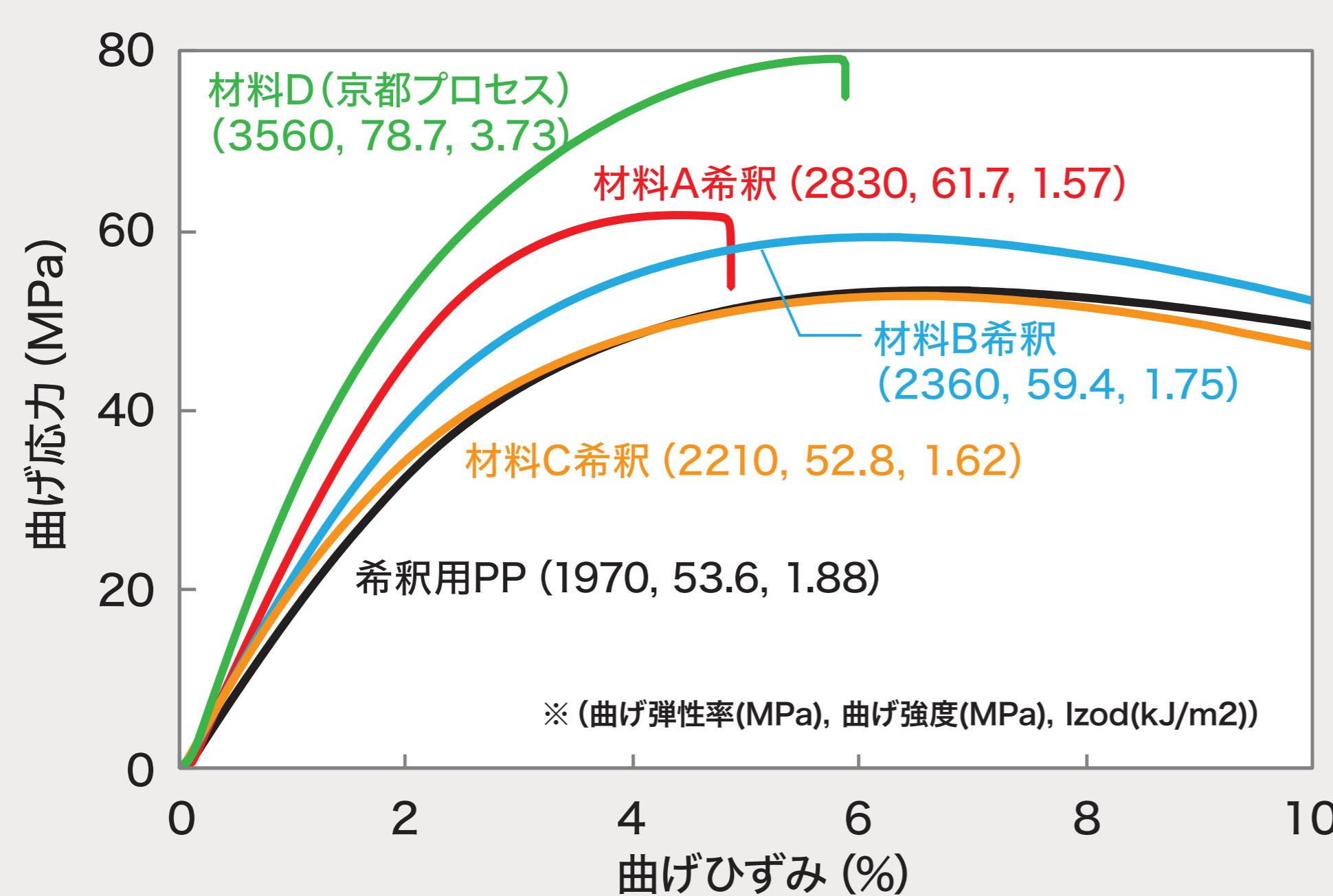
・弾性率、強度:D>A>B>C 伸び:B=C>D>A 耐衝撃:D>A=B=D
